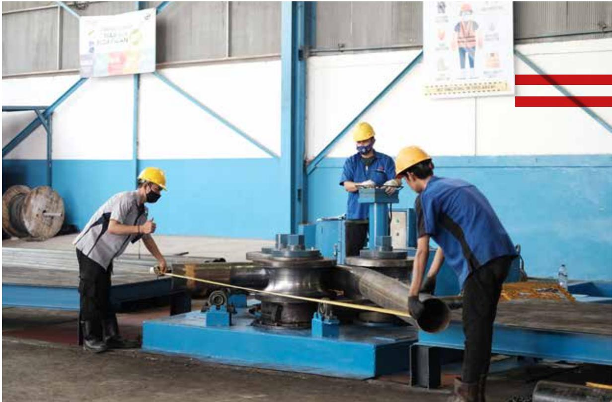
Kapasitas mesin *bending / roll* besi profil kami dapat mencapai material yg cukup besar seperti pipa 12 inch atau Hbeam 250, dilengkapi dengan berbagai ukuran dies dari yang kecil sampai besar, untuk kebutuhan beberapa proyek industri seperti hanggar, *shelter*, *bow roof*, konstruksi *tunnel*, *rail*, jembatan, kuda kuda, dll. Pengerolan dilakukan secara hati-hati oleh tenaga ahli yang berpengalaman, dilakukan dengan jadwal yang ditentukan, dan dengan kualitas pekerjaan yang terjaga.
