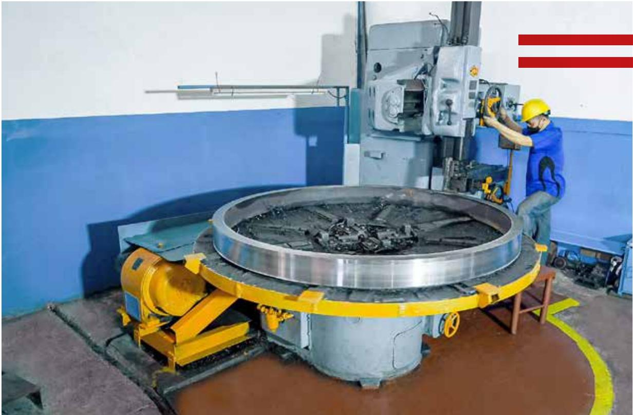
Mesin bubut Carousel, biasanya digunakan untuk bagian-bagian *machining* Industri seperti *Ring Tyre*, *Door Frame*, *Flange* dengan kapasitas maksimum diameter 2500mm. Selain mesin bubut kami juga memiliki mesin bor Radial dengan kapasitas pengeboran Plat besi baik *Carbon Steel*, *Stainless Steel* maupun Plat Hardox dengan maksimal matabor Diameter 60mm. Jasa bubut yang biasa kami kerjakan seperti :
