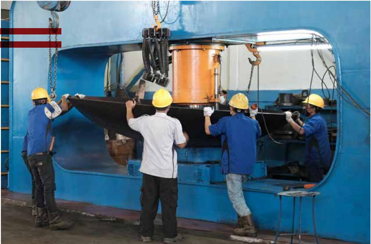
Kami memberikan jasa pelayanan untuk *press plat* sampai ketebalan 50 mm, mesin press kami biasa digunakan untuk pembuatan bodem/*dish head*, *torispherical head*, *ellipsoidal head*, *connical head*. Di dukung dengan operator berpengalaman, kami sanggup mengerjakan pekerjaan bodem atau *dish end* yang cukup besar dan tebal. kami mengutamakan *quality control* untuk bisa menghasilkan kualitas terbaik, serta kami tidak berhenti tapi terus menggali mempelajari agar kami terus berkembang.
